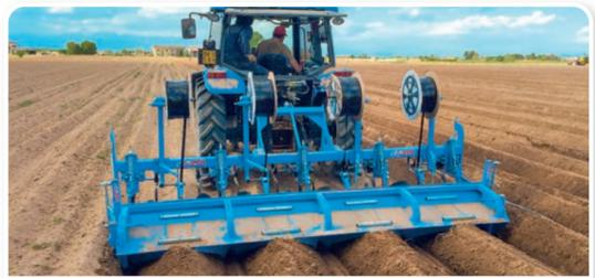
Il vibrobaulatore meccanico SPEDO crea un'ottima forma e stabilità ai bauli sia in terreni sciolti che in terreni di medio impasto. Le molle flex, poste sulla parte anteriore del vibrobaulatore, smuovono il terreno permettendo così ai dischi o assolcatori di formare bauli regolari ed uniformi.
