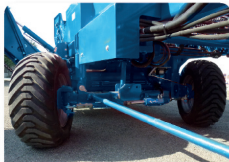
Ruote sterzanti autolivellanti idrauliche Hydraulically steering and self-leveling wheels Roues directrices et auto-nivellées a controlle hydraulique Ruedas hidráulicas de dirección y nivela- ción automática
