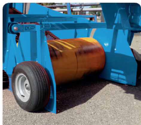
Rullo compattatore e convogliatore per raccolta cipolle Compacting roller and conveyor for onions harvest Compacteur à rouleaux et convoyeur pour la récolte d'oignons Rodillo compactador y transportador para recogida de cebollas
