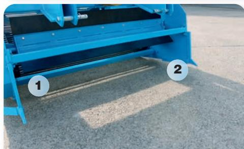
1) Albero di scavo rotante (quadro da 40 mm in acciaio); 2) Le zappette laterali permettono una migliore stabilità della macchina.
