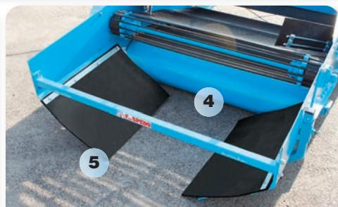
4) Il rullo in ferro Ø 2,45 positioned nella parte posteriore sotto la macchina, permette di compattare il terreno per una raccolta migliore; 5) Gli scivoli posteriori regolabili, ricoperti in gomma, consentono di convogliare le cipolle in un'unica andana senza danneggiarle.
